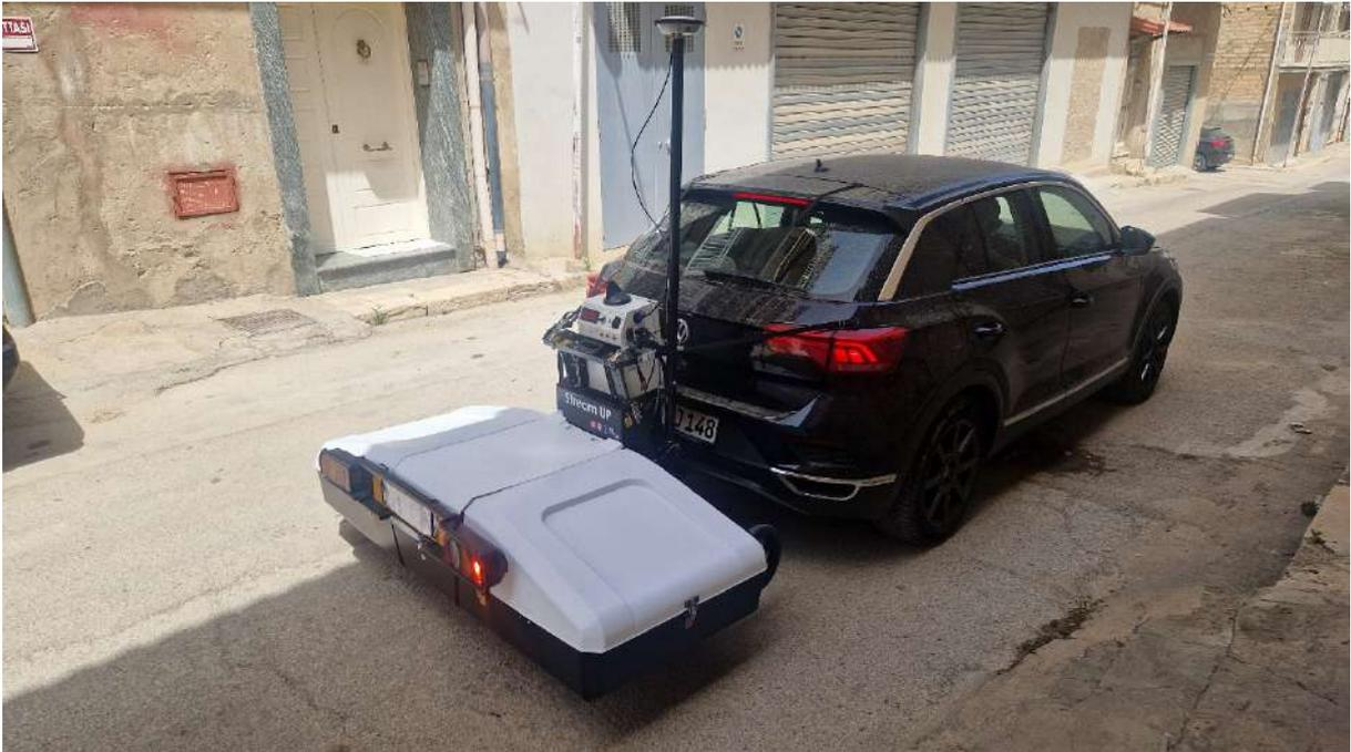
**Figura 9: Acquisizione dati GPR mediante strumentazione trainata da automobile**
