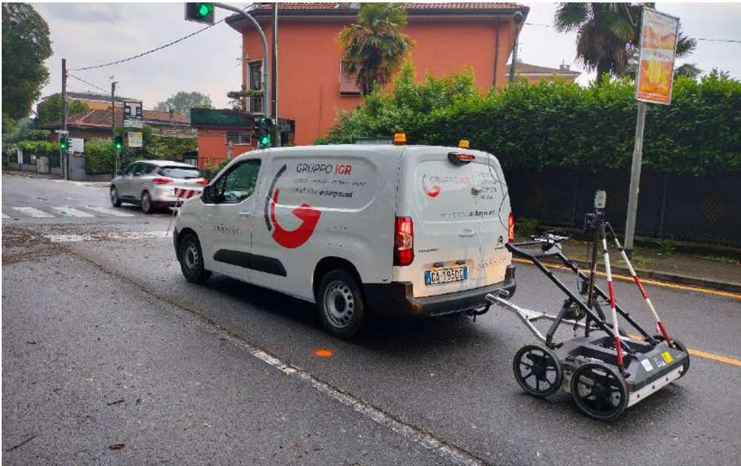
**Figura 13: acquisizione dati GPR mediante strumentazione ad array trainata da veicolo a motore**
