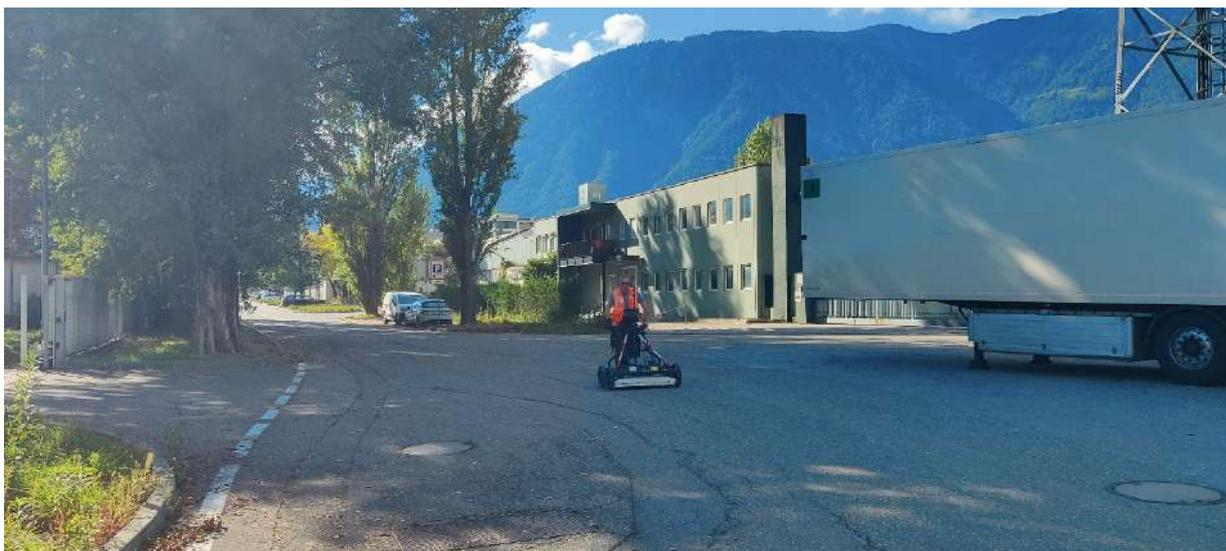
**Figura 1. Acquisizione dati georadar mediante strumentazione IDS StreamDP**
