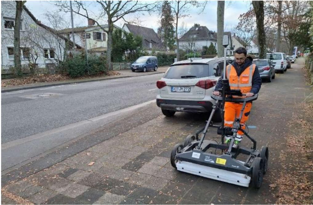
**Figura 7: Acquisizione dati mediante scansioni longitudinali all'asse di progetto**
