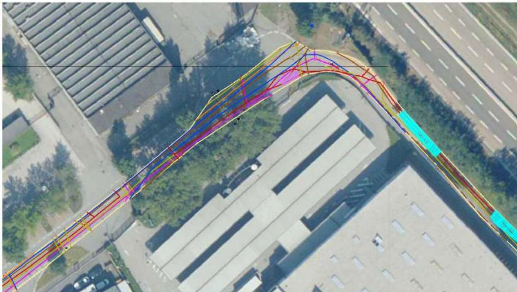
**Figura 4: Esempio di cartografia finale con rappresentazione delle condotte rilevate**
